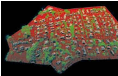
DTM-AV swissimage (oben); Höhenbestimmung auf der Basis von LIDAR-Daten, Hochschule für Technik und Wirtschaft des Kantons Waadt (unten)
